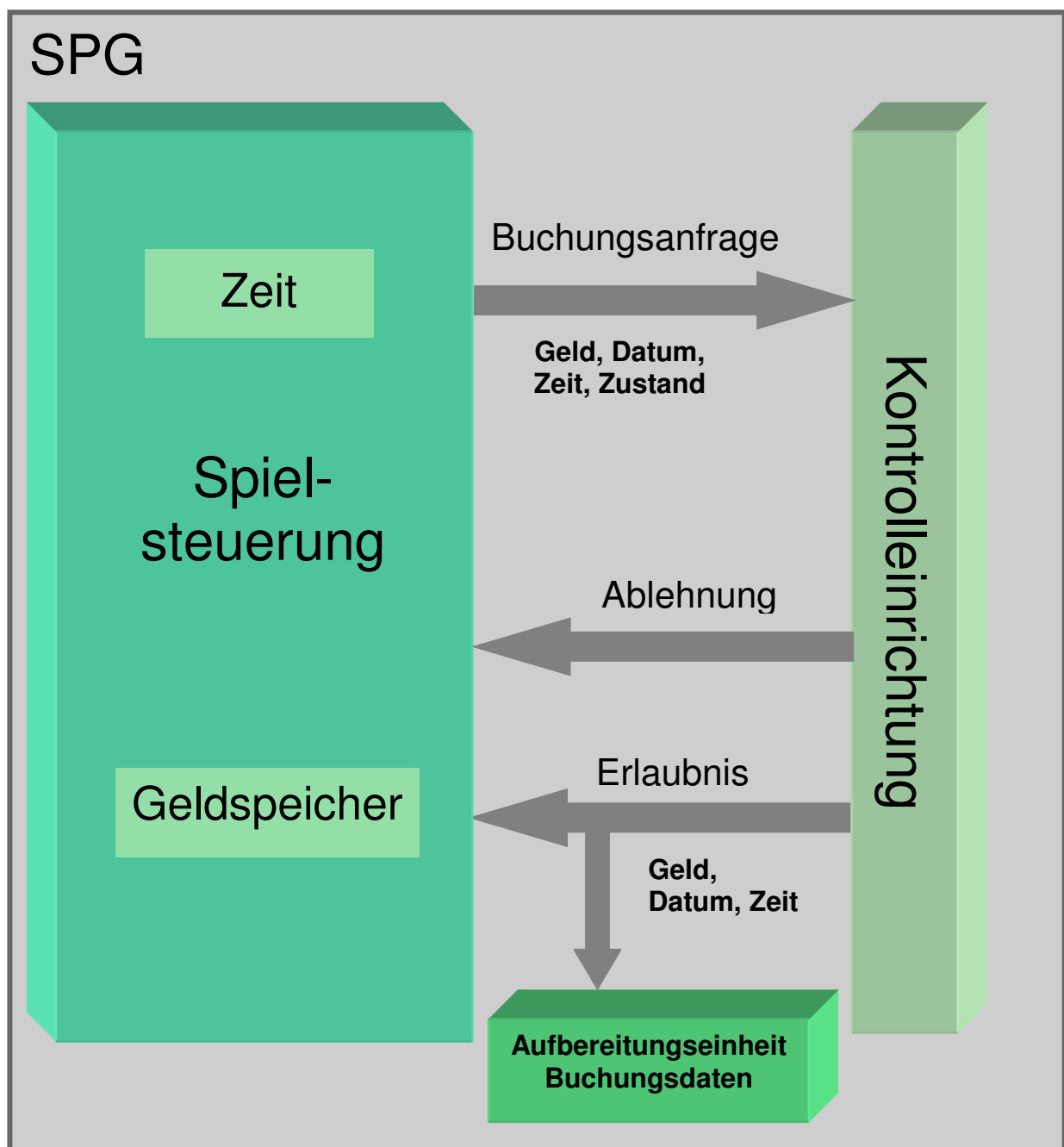
Bild 6.1: Einbindung der Kontrolleinrichtung
